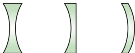
เลนส์นูนเว้าสองหน้า เลนส์เว้าแกมระนาบ เลนส์เว้าแกมนูน
